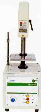
電動立式機台 Vertical Electric Test Stand
