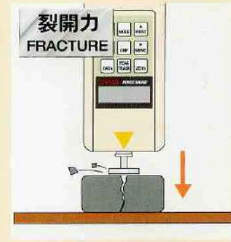
玻璃、碳、陶瓷、塑膠等新材料的裂開力峰值抓取。
