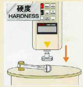
硬度測試：藥錠、水果、口紅、黏度的測試。
