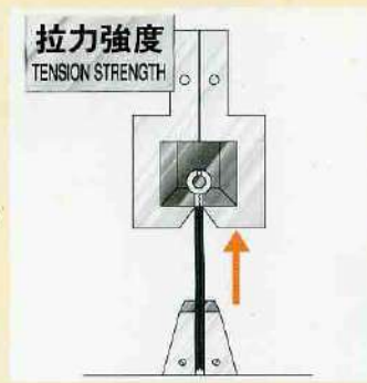
拉力強度試驗：端子的拉力強度、鉚接強度試驗。
